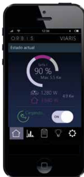
Az otthon és a jármű töltési állapotának és energiafogyasztásának valós idejű leolvasása.
