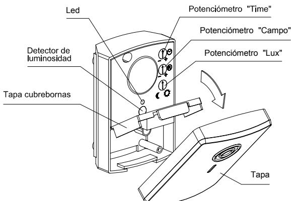
El interruptor de proximidad ECOMAT es capaz de detectar el más mínimo movimiento gracias a su tecnología de alta frecuencia. Su precisión de detección no depende de la temperatura ambiente. Detecta de forma inmediata cualquier movimiento, incluso elementos inertes como por ejemplo: puertas o sillas. El ECOMAT detecta en un campo de acción de 0,5 a 6 metros con 270° de cobertura.
